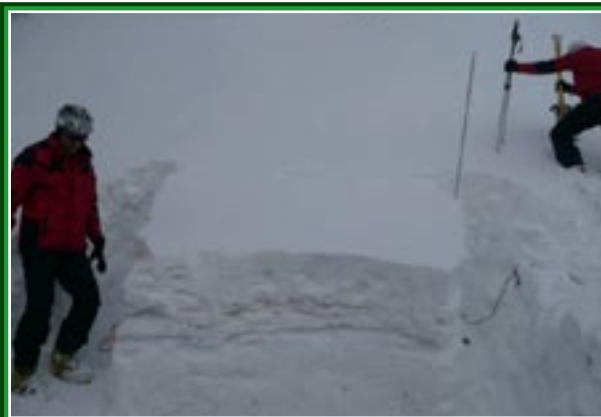
Die Gruppe der Alpenen Einsatzgruppe Mürzzuschlag beim Rutschblocktest. Der Schneedeckenaufbau der Schattlagen war ungünstig. Foto: AEG Mürzzuschlag
