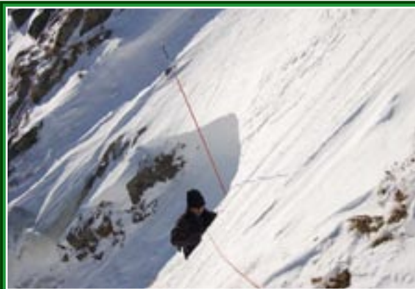
Aufnahme eines Schneeprofiles beim Anriss des Lawinenunfalls vom Talkenschrein. Foto: LWD
