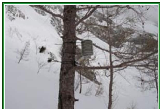
Am Stamm einer Lärche befestigtes Temperaturmessgerät im Bereich zwischen Franzosenkreuz und Voisthalergasse im Hochschwabmassiv. Foto: A. Pilz
