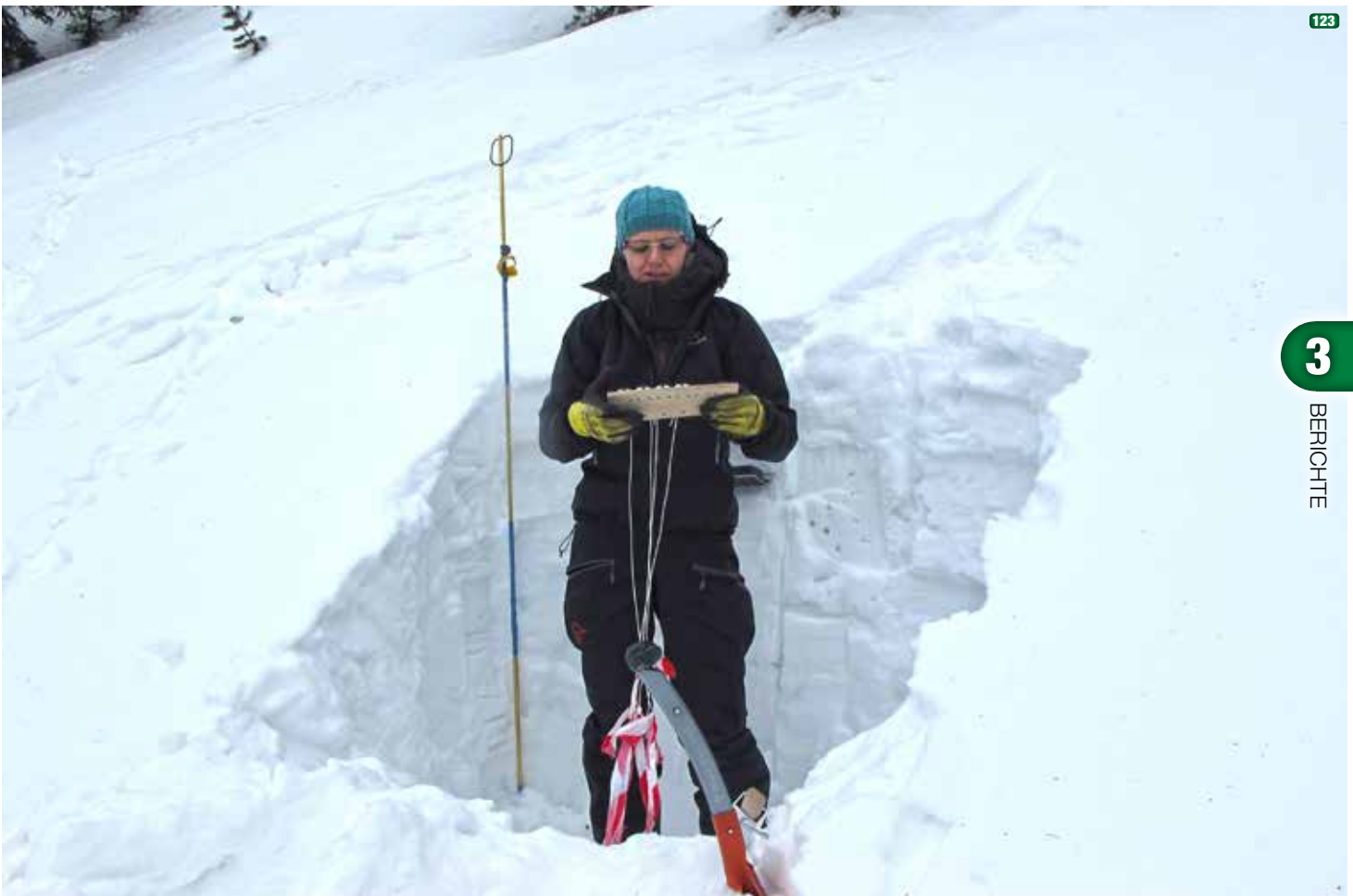
123 Irene bei der Vorbereitung der Elastizitätsmessung mittels Beschleunigungssensoren. (Foto: LWD) |
