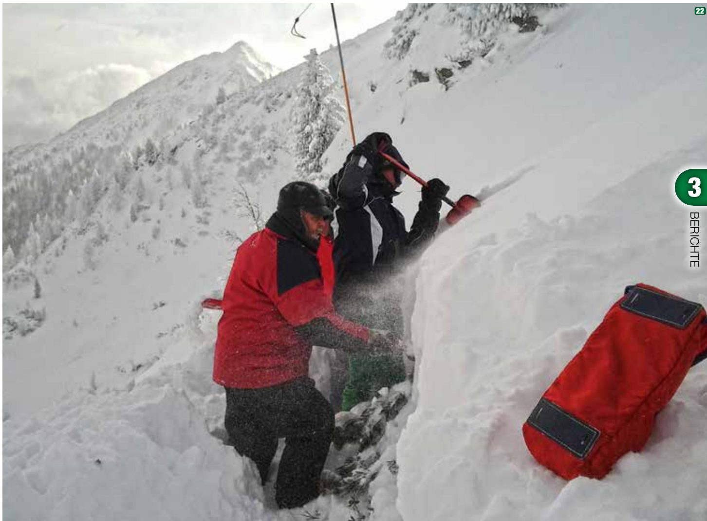
22 Vorbereitungen für einen Rutschblocktest: Trotz des frühen Termins fanden wir auf der Reiteralm bis zu einem Meter Schnee vor. (Foto: LWD) |
