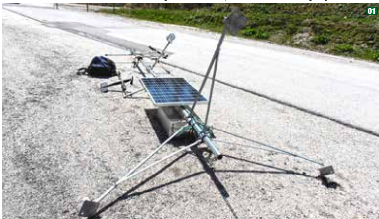
07 Am Gstemmer erwies sich der Untergrund als suboptimal für die Befestigung, dennoch hielt die Abspannung allen Belastungen stand. (Foto: LWD) |
