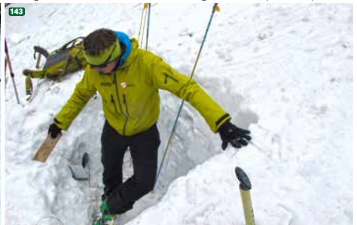
143 Wichtig ist ein „Schütteln“ der Sensorik vor und nach den Messungen, damit man die Auswertungen der unterschiedlichen Sensoren vergleichen kann. (Foto: LWD) |
