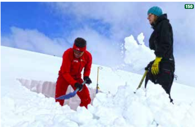
151 ...Seitenwand die Messsensoren in die ungestörte Schneedecke eingebracht wird. (Foto: LWD) |
