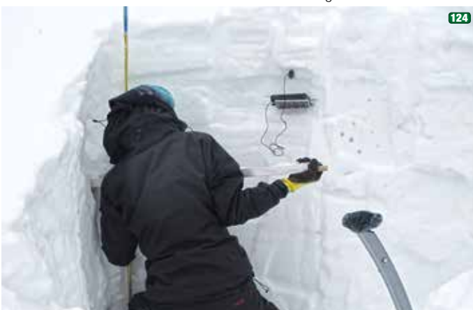
125 Blick auf die unterschiedlichen Schichten mit der eingebrachten Mess-Sensorik. (Foto: LWD) |
