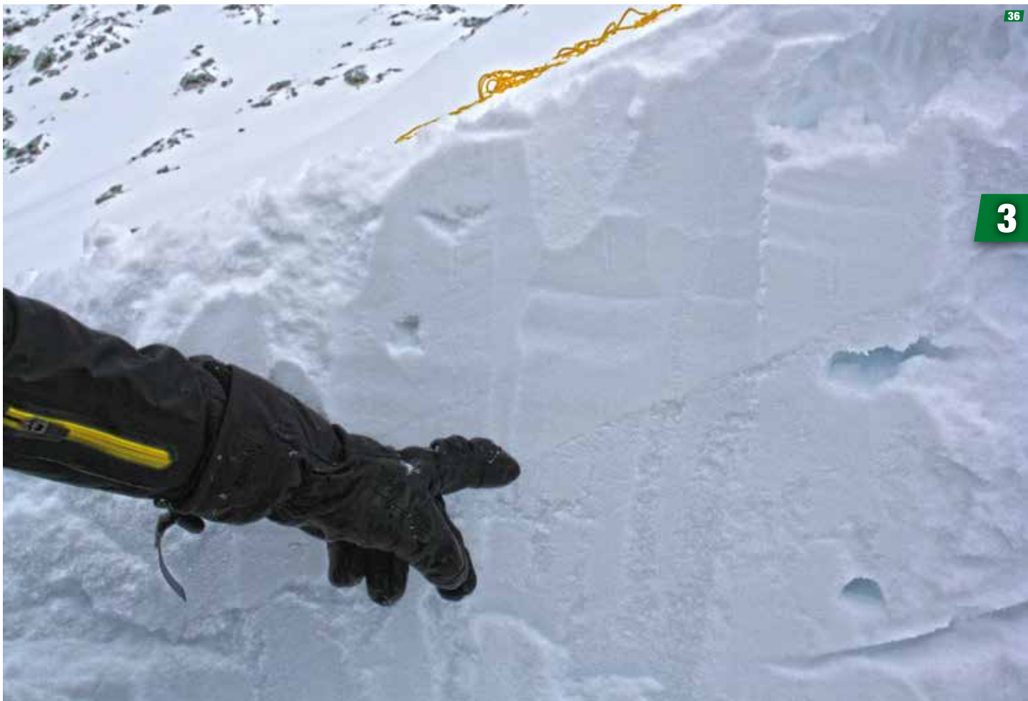
36 Eine deutliche Schichtgrenze (dünner Harschdeckel) zwischen ca. 30 cm Neuschnee und der kantig aufgebauten Altschneedecke. (Foto: LWD Steiermark) |
