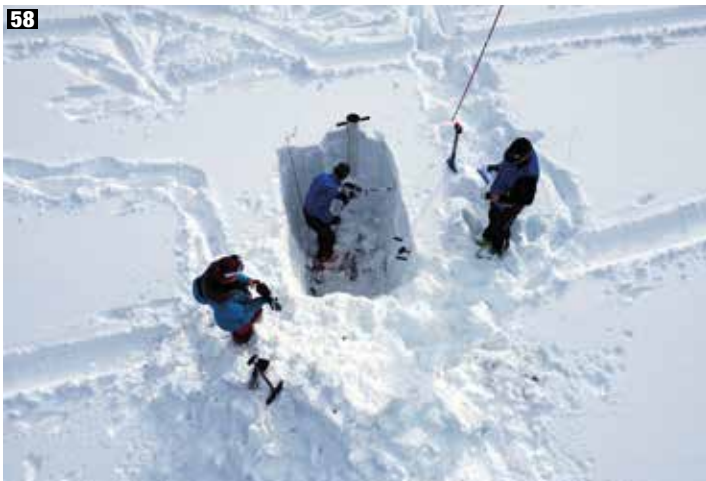
58 Schneelastmessungen der ZAMG Innsbruck/Wien. (Foto: Anton Neureiter, 16.02.2022) | 59 Winddünnung im Bereich der Tuxer Alpen. (Foto: Alois Stöckl, 03.02.2022) |
