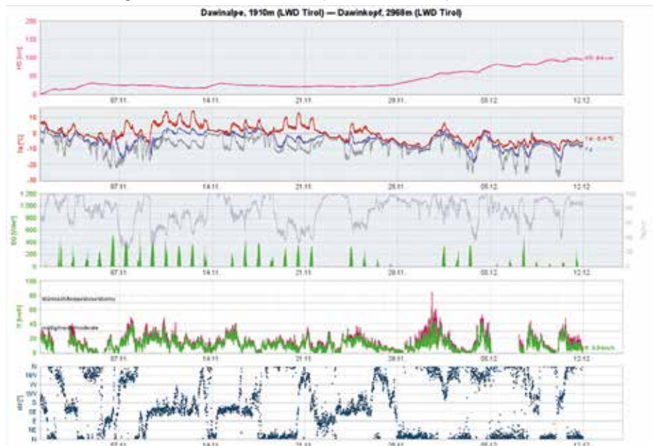
115 Daten einer etwas nordwestlich gelegenen Wetterstation. Während des niederschlagsarmen Novembers schritt die aufbauende Umwandlung voran. Ab Ende des Monats kam unter Windeinfluss einiges an Schnee zusammen. (Quelle: LWD Tirol) |
