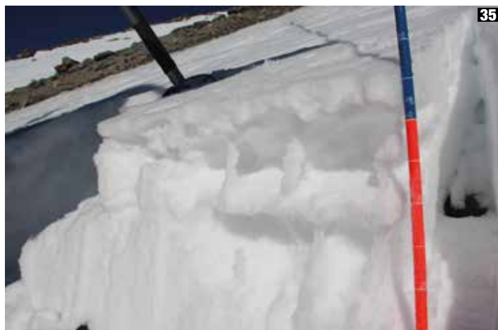
34 Fortschreitende Ausaperung im besonnten Gelände. Osttiroler Tauern. (Foto: Robert Trost, 16.01.2022) | 35 Schneeprofil auf 2685 m, SW, 36°. Interessant sind die zwischen und unterhalb von Schmelzkrusten vorhandenen, gefrorenen Wasserkanäle, welche stabilisierend wirkten. (Foto: LWD Tirol, 19.01.2022) |
