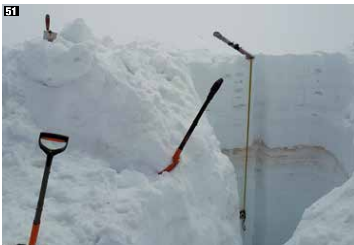
50 „Powder“ am Sonnblick Ende April. (Foto: Tímea Mareková, 28.04.2022) | 51 Schneeprofilanschacht für Massenbilanzmessung am Gletscher, Sonnblick. (Foto: Tímea Mareková, 28.04.2022) |
